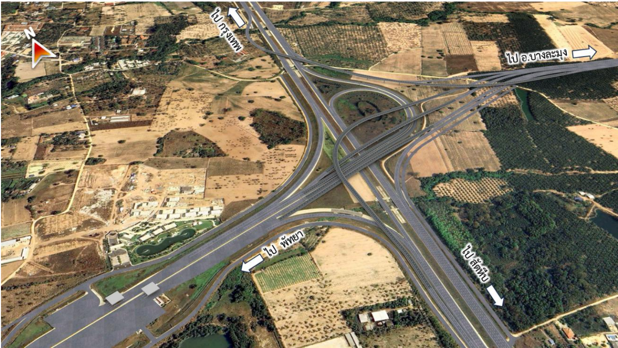
รูปที่ 6-13 รูปแบบทางแยกต่างระดับห้าชั้นใหญ่ที่เหมาะสม ตามแนวเส้นทางเลือกที่ 1
